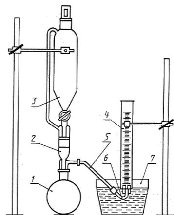
1 - колба лабораторная круглодонная; 2 - переход с одной горловиной и отводом; 3 - капельная воронка;
