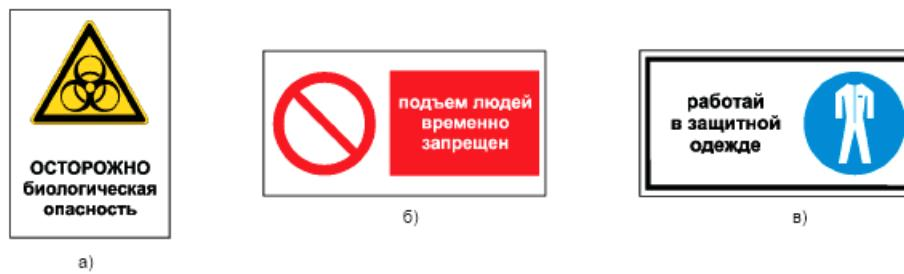
а) - текст расположен ниже знака безопасности; б) - текст расположен справа от знака безопасности; в) - текст расположен слева от знака безопасности
