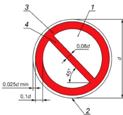
$d$  - диаметр круга; 1 - основная поверхность; 2 - кант; 3 - кайма; 4 - поперечная полоса
