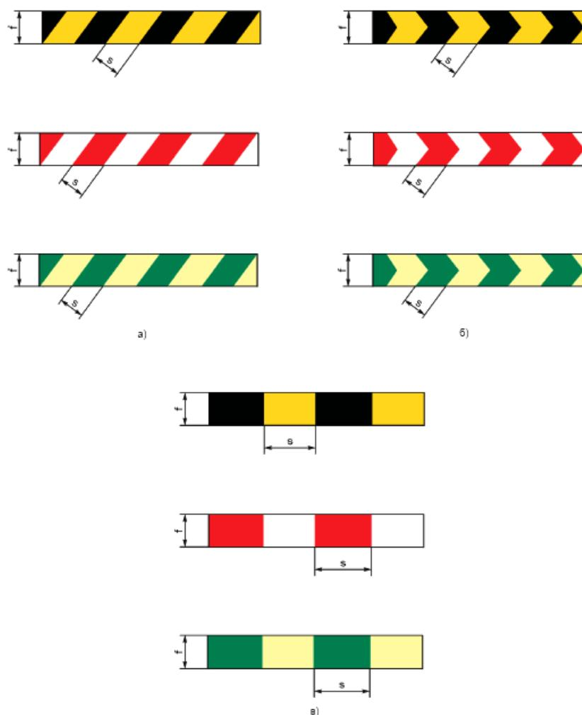
а) - расположение полос наклонно; б) - расположение полос зигзагообразно в виде "елочки"; в) - расположение полос прямо (вертикально или горизонтально),  $s$  - поперечный размер сигнальной разметки,  $s$  - ширина полосы сигнального цвета.
